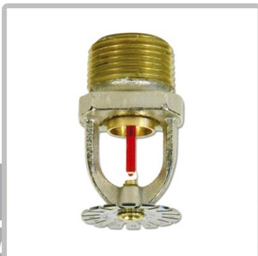
• Marca: Tyco • Modelo: EC-8 • Código: TY4232 (pendent) • Sello: UL y FM • Respuesta: Rápida • Cobertura: Extendida • Fusible: Ampolla de 3 mm • Coeficiente de descarga: K=8.0 (115,2) • Diámetro de rosca: 3/4" (19 mm) • Terminación: Bronce, Cromado, Blanco
