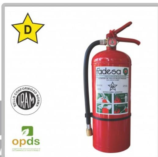
**MANUAL Características:** • Recipiente de chapa de acero soldado sistema MIG. • Válvula de latón forjado con manómetro indicador de presión. • Tratamiento superficial de alta resistencia a la corrosión: decapado mecánico, fosfatizado, pasivado y pintado con pintura en polvo poliéster. • Manga de caucho sintético.
