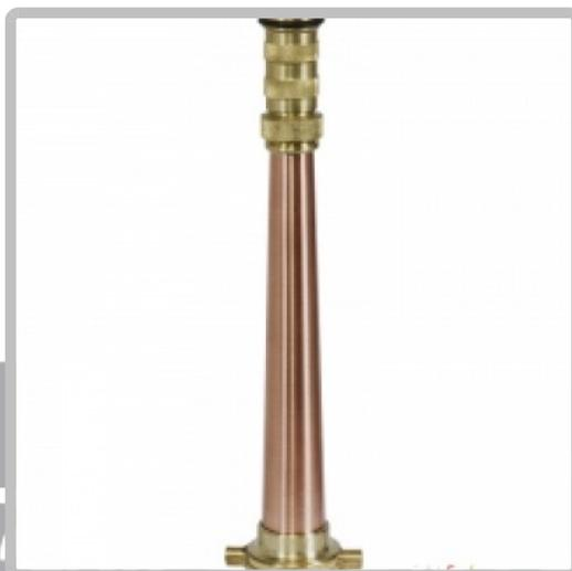
Lanza con boquilla chorro pleno y niebla para el servicio de seguridad contra incendio en hidrantes u otros usos. Construida con tubo cónico de cobre y extremos de bronce forjado. Marca TGB
