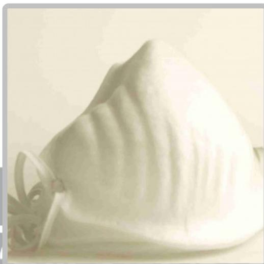
Respirador descartable contra partículas N95, sin válvula. Posee doble banda elástica para un mejor ajuste, mayor eficiencia (95% de retención). El área del puente nasal esta preformado y no requiere bandas metálicas de ajustes. Usos recomendados: Tareas de limpieza, pulido, procesamiento de alimentos, laboratorios u otros trabajos en los que se produce polvo. Ensayado en nuestro Laboratorio de Calidad y aprobado según Norma IRAM 3646 y 3649
