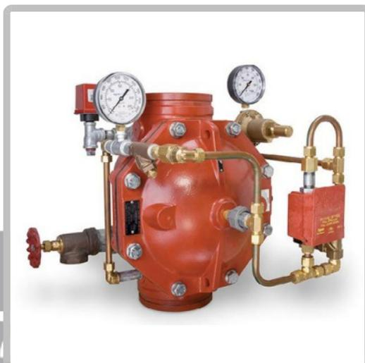
Los sistemas de diluvio con actuator eléctrico son comúnmente utilizados en instalaciones de incendio donde se busca aplicar la descarga de agua mediante el empleo de rociadores abiertos y donde la apertura de la válvula se acciona ante el disparo un sistema de detección electrónica o activación manual. Incluye: • Válvula Diluvio (DV-5) • Trim completo • Alarma con motor hidráulico (WMA-1) • Válvula mariposa (BFV-300) • Detector de flujo (VSR) • Presóstato de Agua (PS-10) • Válvula solenoide
